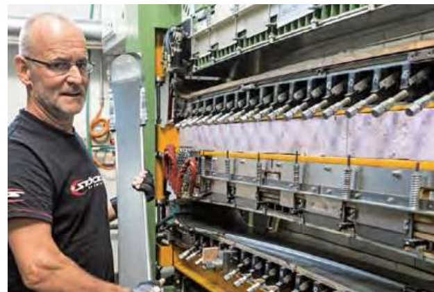
Energetische Optimierung erhöht die Effizienz: Ein Ski-Vorfabrikat wird in die optimierte Skipresse eingelegt.
